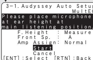
ここでは、サラウンドバックスピーカーを使用した 7.1 チャンネル再生の設定のしかたについて説明しています。サラウンドバックスピーカーを使用した 7.1 チャンネル以外の設定のしかたは、“Amp Assign”を選び、「スピーカーを設定する」(☞39 ページ)の手順3と4の操作をおこなってください。
