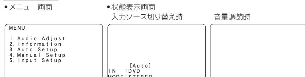
状態表示：入力ソースの切り替えや音量調節時、一時的に画面に操作状態を表示します。
