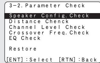
**Speaker Config. Check** スピーカーの構成を確認します。
